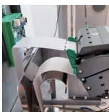
Entrée avec l'imprimante pour 10'000 tickets
